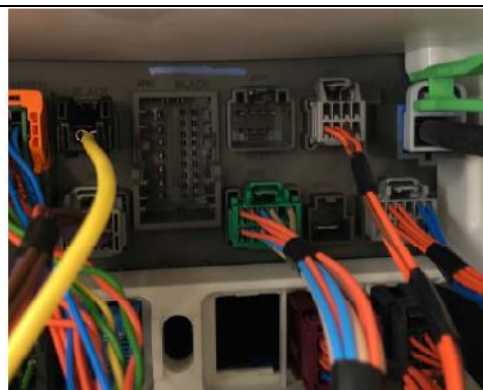
Connexion du faisceau au boîtier de distribution électrique face B
