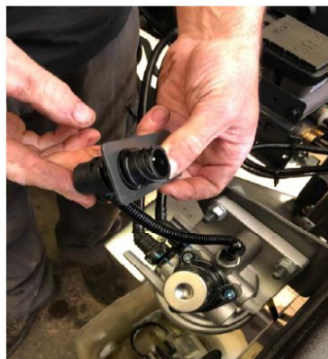
Connexion du faisceau au boîtier de distribution électrique face B
