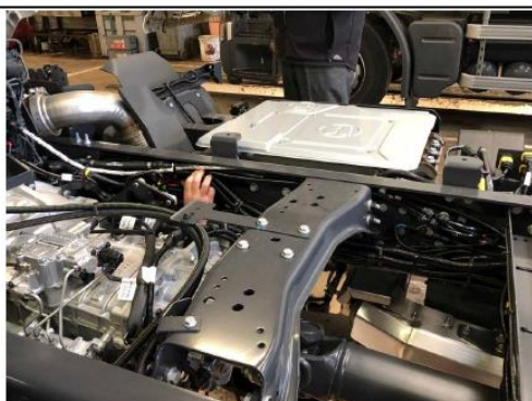
Passage du faisceau sur châssis
